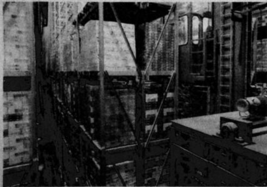
In dem Tiefkühl-Hochregallager können über 8000 Paletten gelagert werden. Jede Palette ist durch ein ferngesteuertes Hubgerät einzeln greifbar.
